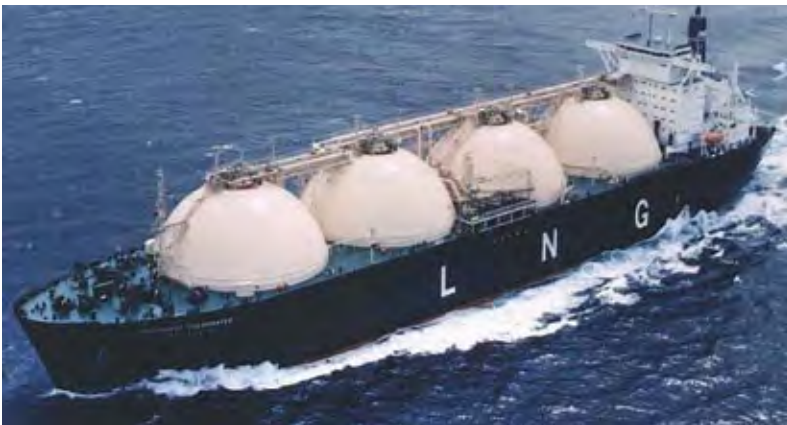
LNG Carrier – Moss type (approx. 138 000m 3 )
