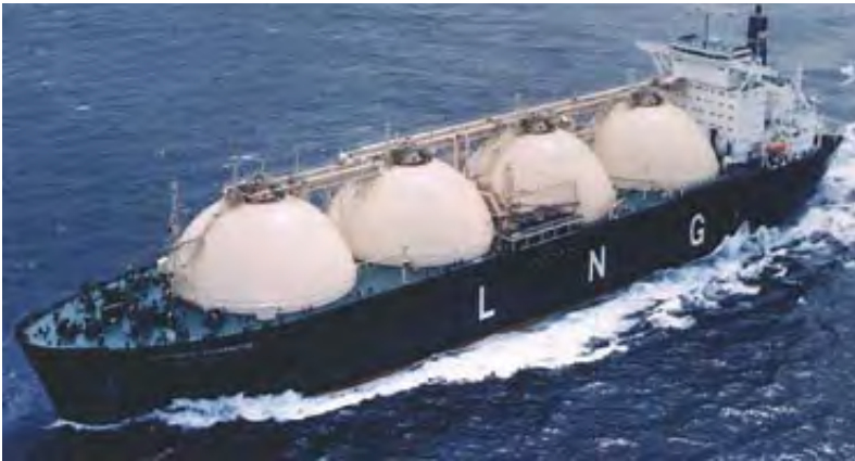
LNG Carrier – Moss type (approx. 138 000m 3 )
